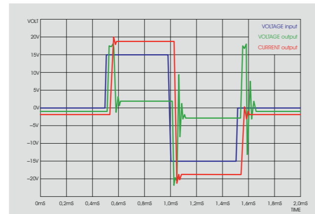
Abb. 2: iTRON AA Stromverstärker Simulation an 2 Wege Box
