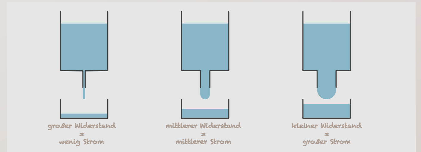
Wasserbehälter mit identischem Wasserstand, bzw. Druck (= Spannung).
